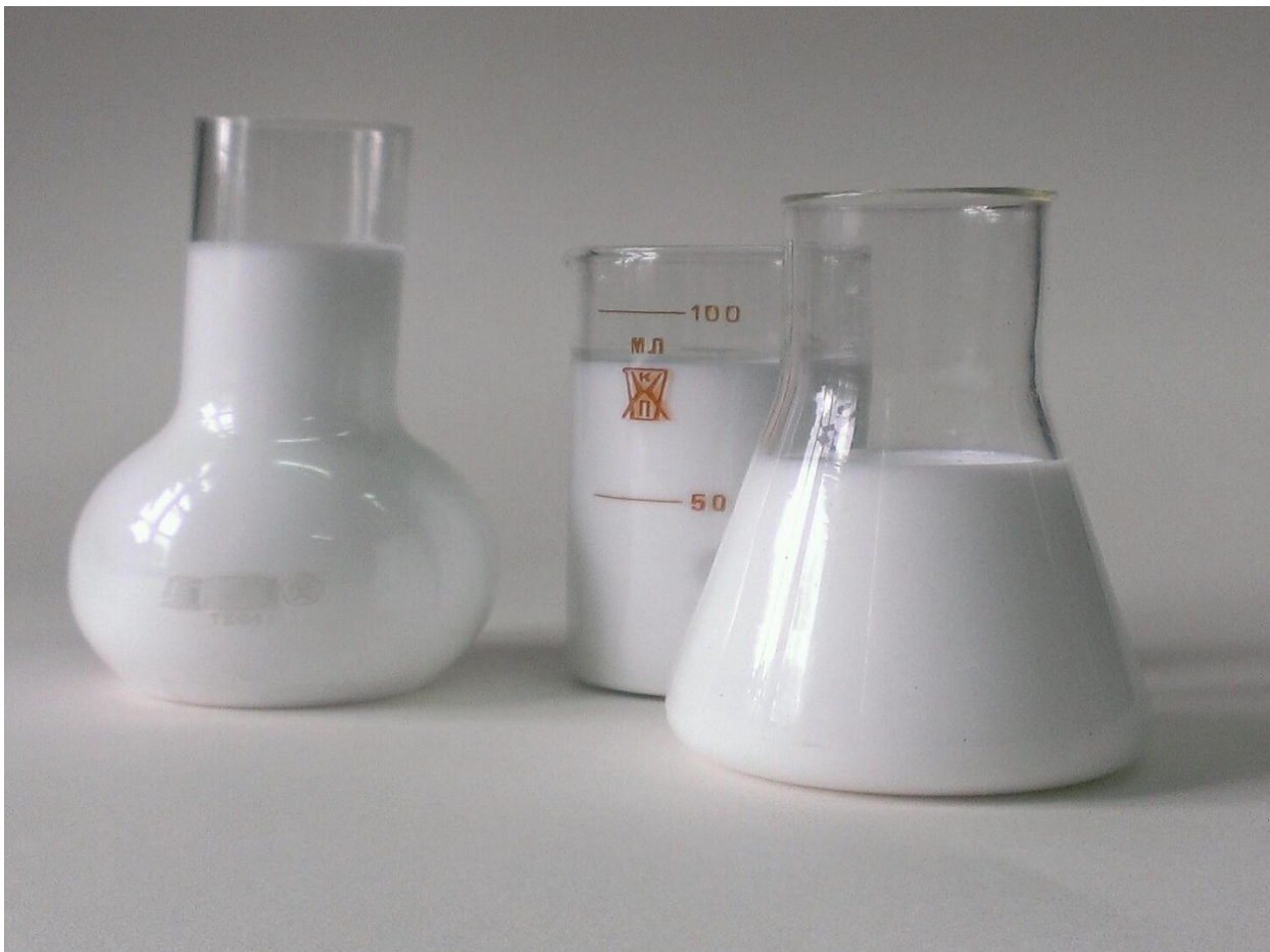
Рис.5.9. Устойчивые водные дисперсии эпоксидной смолы ЭД-20 разработанные по этапу 5.2.3.
