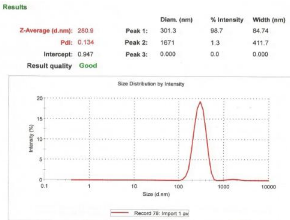
Рис. 6.23. Средний размер частиц дисперсии импортного производителя
