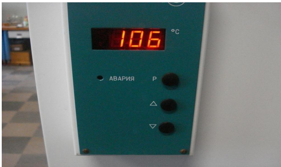
Рис.2.9. Сушильный шкаф для термообработки тестируемых волокнистых материалов
