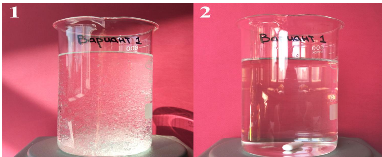
Рисунок 2.8. Фото начала и окончания проведения гидролиза органофункциональных силанов
