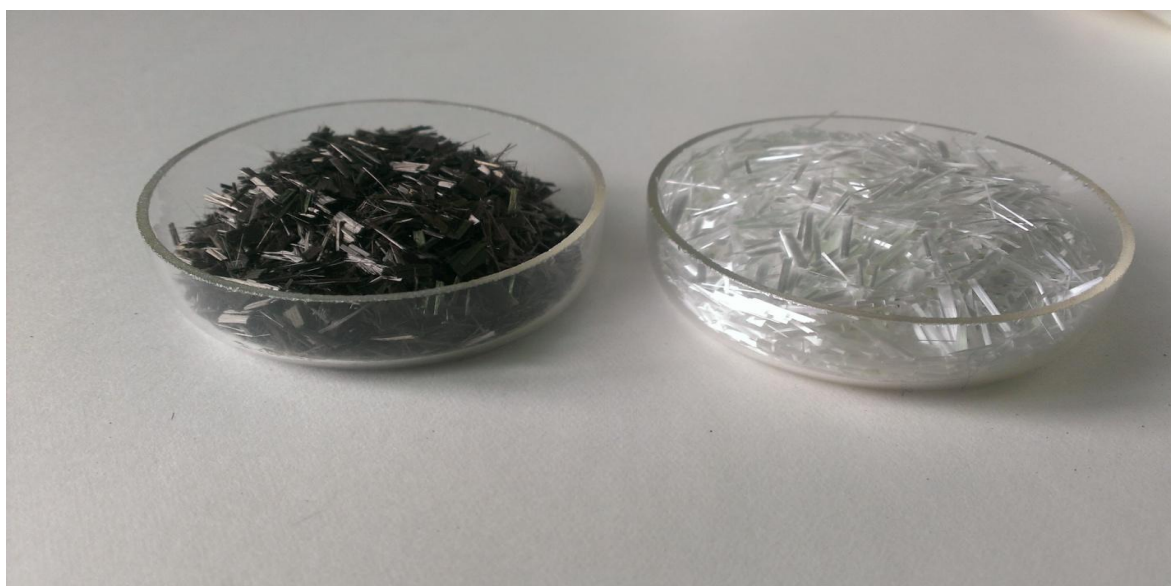
Рисунок 2.4. Внешний вид базальтового и стеклянного типа E рубленных волокон
