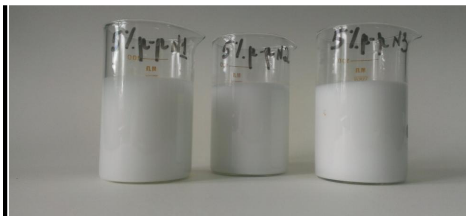
Рис. 5.6. Изучение стабильности 5%-ных дисперсий смолы ЭД-20 при хранении
