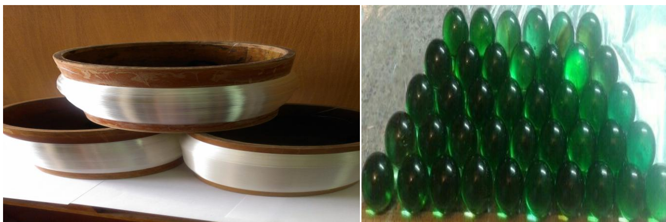
Рисунок 2.2. Стеклонить высокопрочная ВМПС10-40 и стеклошарики магнийалюмосиликатного стекла типа ВМП.
