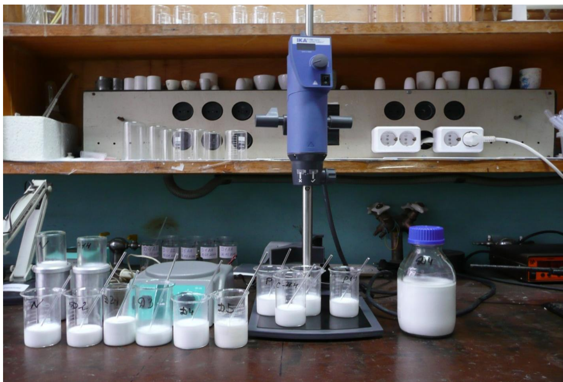
Рис.2.15. Диспергирование с помощью лабораторной мешалки ИКА Т 25 digital Ultra TURRAX
