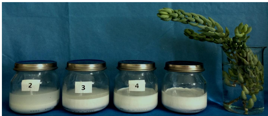
Рис 5.5 Внешний вид полученных водных эмульсий эпоксидной смолы ЭД-20 с использованием этоксилированных алкилфенолов в качестве эмульгаторов
