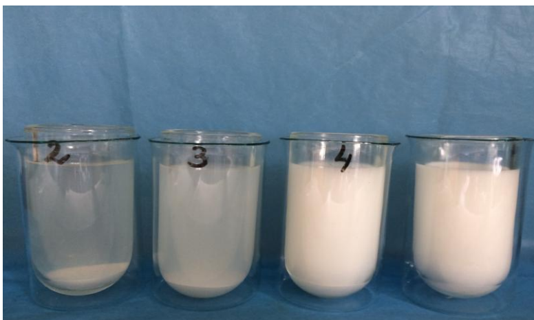
Рис. 5.8. Внешний вид 5%-ных водных дисперсий после центрифугирования при 5000 об/мин в течение 10 минут.
